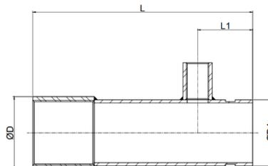
Questo adattatore consente il collegamento tra due parti di impianto passando da una sezione con filetti a una sezione con giunti scanalati. Il manicotto offre diverse modalità d'uso:
