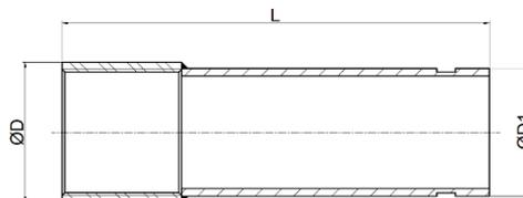
Questo adattatore consente il collegamento tra due parti di impianto passando da una sezione con filetti a una sezione con giunti scanalati.
